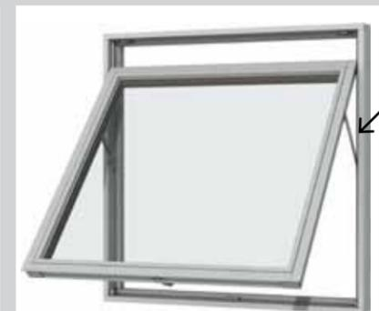
► **Friktionsbremsen** kan fastholde det åbne vindue i vilkårlig ventilationsstilling ved normale vejrforhold. Hvis det blæser meget, skal du dog bruge ventilationsstillingen, der er indbygget i grebet. Friktionsbremsen, der bruges i det topstyrede vindue, er justeret fra fabrikken, så den passer til vinduets størrelse. Synes du, at vinduet går for stramt eller for løst, kan du justere friktionsbremsen (se under selve vinduestypen).
